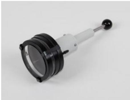
Pour visualiser les trajectoires de particules a ; brève durée de condensation du mélange alcool/vapeur d'eau dont la sursaturation par détente adiabatique est obtenue au moyen d'une pompe à air manuelle ; couvercle avec fenêtres en verre acrylique pour l'observation et le passage de la lumière ; douilles de raccordement pour tension de drainage servant à désioniser et support pour préparation de radium ( 559596 ).
