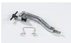
Agrafe d'assemblage pour fixer le jog sur le noyau en U du transformateur d'expérimentation.
