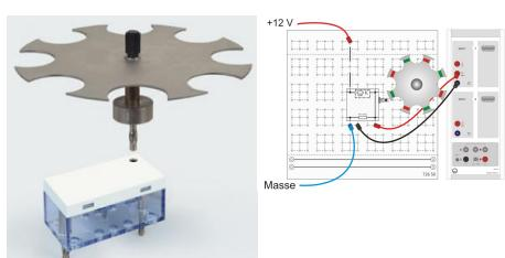
Élément enfichable STE avec indicateur de position du volant moteur pour 582624, 582625 et 5826241.
