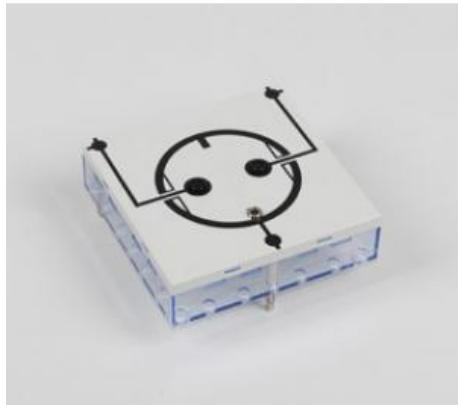
Représentation agrandie d'une prise à contact de protection sur un élément enfichable. Avec douilles pour la phase, le neutre et la terre.
