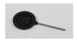
Capsule à electret, pour étudier le son à l'appui d'expériences simples, dans monture, avec douilles de raccordement, sur tige.
