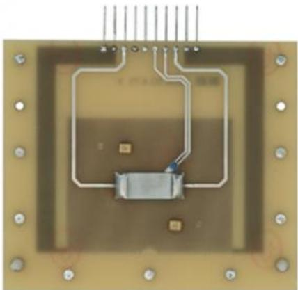
Platine amovible pour l'étude de la conductivité pour du germanium non dopé en fonction de la température. Cristal de Ge brasé sur une platine amovible pour l'appareil de base pour l'étude de l'effet Hall, avec des contacts pour le courant transversal, chauffage par résistance intégré avec thermo-sonde directement sous le cristal.
