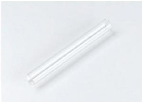
**Tube à réaction en verre quartzeux 160 x 20 mm Ø**
