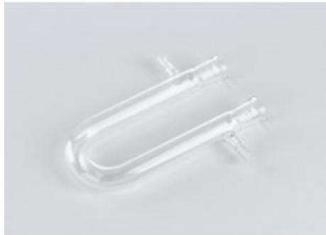
Pour l'électrolyse et le séchage des gaz
