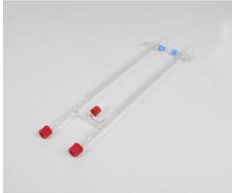
Gradué, avec 2 raccords filetés GL 18 et 1 raccord fileté GL 14 pour l'électrolyseur en U (voltamètre d'Hofmann).
