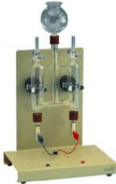
Pour produire de l'hydrogène (et de l'oxygène) à l'aide du courant électrique. La cellule d'électrolyse est construite de façon à être très compacte et fixée au support avec des pinces à ressort. Les électrodes de platine sont fixées à l'élément en verre par des raccords filetés. La cellule d'électrolyse peut aussi servir de voltamètre d'Hofmann. L'énergie électrique nécessaire peut être fournie par une alimentation ( 521 230 ), le panneau solaire ( 664 431 ) ou l'éolienne ( 664 430 ).
