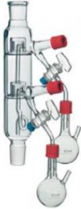
**Colonne pour distillation fractionnée, 2 plateaux, 280 mm, 2 RN 29/32, 2 GL 18**
