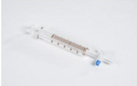
Pour mesurer et prélever un volume de gaz défini. Le corps cylindrique est gradué tous les 1 ml. Le verre SVL (à rodage de précision) garantit une parfaite étanchéité avec une grande souplesse de déplacement du piston ainsi qu'un ajustage parfait des éléments entre eux.
