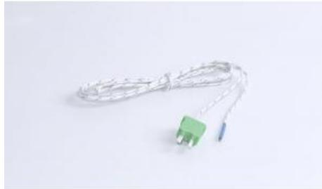
Thermocouple NiCr-Ni avec connecteur miniature de type K pour la mesure instantanée de la température dans l'air, les gaz et les liquides, isolé à la soie de verre, sans poignée.
