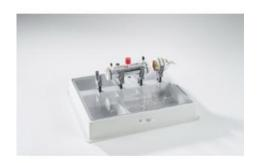
Pour la réalisation d'expériences avec le rayonnement infrarouge (rayonnement thermique), tout particulièrement sur l'absorption du rayonnement IR par le gaz carbonique et les autres gaz à titre de comparaison (effet de serre). Le kit se compose d'un émetteur IR, d'une cuve de mesure réfléchissante et d'un support pour la pile thermoélectrique de Moll.
