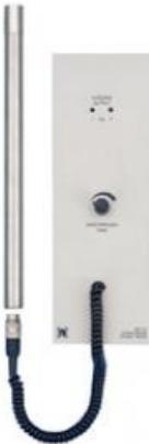
Pour la mesure de l'éthanol dans les milieux aqueux et gazeux, par ex. pour définir la concentration d'éthanol dans les liquides lors de fermentations. Le capteur à plaque filtrante en céramique est logé dans un boîtier en acier inoxydable ; la sensibilité peut être adaptée à la mesure considérée par un gain réglable. Une sortie analogique permet la connexion d'un enregistreur à compensation ou d'un ordinateur avec interface.
