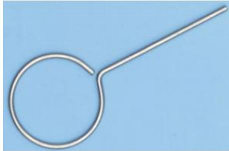
Sert de support aux toiles calorifuges et aux récipients posés dessus, inoxydable.
