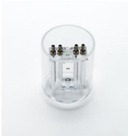
Réservoir pour l'hydrogène et l'oxygène nécessaire à la pile à combustible PEM réversible ( 667 4044 ) pour générer l'énergie par hydrolyse.
