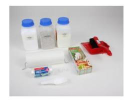
Assortiment de produits chimiques et d'accessoires pour le cours de chimie permettant l'élimination aussi rapide et méticuleuse que possible des produits chimiques renversés. Tous le nécessaire est rangé dans un support mural robuste.
