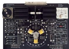
La carte d'expérimentation pour les cours COM4LAB sur les machines asynchrones, les machines synchrones et les machines à courant continu (disponibles séparément).
