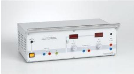
Appareil d'alimentation complet pour l'enregistrement des caractéristiques de machines électriques à tension constante pour la gamme de puissance jusqu'à 1,0 kW, en rack 19
