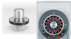
Roue polaire avec **20 aimages encas**trés, à utiliser dans le stator 727 815. Deux aimants sont respectivement réunis pour ainsi former un pôle. Les pôles nord et sud sont marqués en couleur. Avec poulie pour l'entraînement par le biais de l'unité d'entraînement 727 88.
