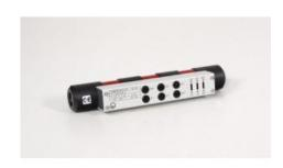
Chariot mobile avec trois bobines monté sur roulements à billes, bornes des bobines avec douilles de sécurité 4
