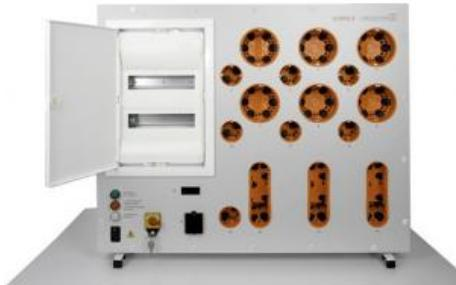
Mur de montage pour la réalisation d'exercices pratiques dans le domaine de la technique d'installation. Équipé d'une distribution secondaire et de divers boîtiers d'installation encastrés (boîtiers de dérivation et boîtiers d'interrupteurs) reliés entre eux par des tubes. Ceux-ci sont conçus de manière à pouvoir accueillir aussi bien des câbles NYM que des fils individuels.
