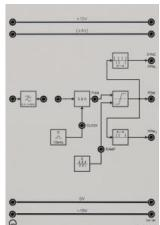
A partir du signal modulant, il est généré une modulation d'impulsions en durée PDM par le pas intermédiaire de l'échantillonnage (établissement d'une PAM(MIA)) selon le procédé des impulsions en dents de scie. Une différentiation finale du signal PDM donne la modulation d'impulsions en phase. L'information nécessaire pour la synchronisation du récepteur est transmise avec les données utiles pour les deux modulations d'impulsions dans le temps. Le modulateur PTM (MIT) est équipé de:
