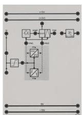
Le démodulateur PTM (MIT) reconvertis les modulations d'impulsions dans le temps PPM (MIP) et PDM (MID) en PAM (MIA).
