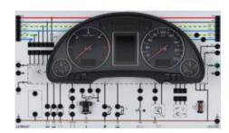
Combiné d'instruments avec compte-tours, tachymètre, affichage de la température et de la réserve de carburant, à affichage graphique haute résolution d'informations pour le conducteur.
