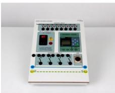
Module de logique universel LOGO universel! 8 230RCE avec simulation de signal d'entrée.
