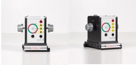
Pour détecter la position du rotor d'un moteur à courant continu sans balais et à aimants permanents (machine synchrone auto-pilotée).
