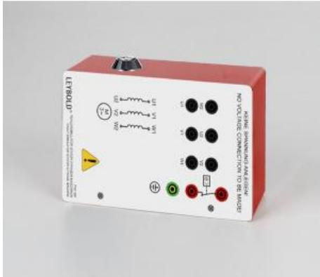
Le simulateur de défauts permet, en combinaison avec les moteurs asynchrones triphasés à cage d'écureuil, de simuler des défauts typiques tels que le défaut à la terre, l'interruption de l'enroulement, le défaut de spire, le défaut d'enroulement et la réponse du thermocontact.
