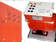
Le simulateur de défauts permet, en combinaison avec les moteurs asyrichrones triphasés à cage d'écureuil, de simuler des défauts typiques tels que le défaut à la terre, l'interruption de l'enroulement, le défaut de spire, le défaut d'enroulement et la réponse du thermocontact.
