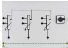
Trois résistances à réglage synchrone en 6 paliers, pour moteur à rotor bobiné et machine multifonction 1,0 kW.
