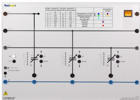
Trois batteries de condensateurs à papier métallisé comprenant chacune 4 condensateurs.
