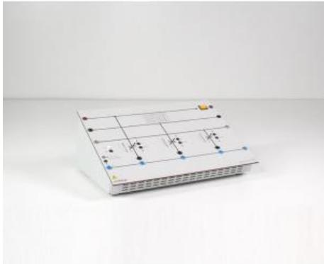
Charge capacitive triphasée, robuste et à usage universel, avec une puissance absorbée réglable jusqu'à 1 kvar. La capacité de chaque phase peut être modifiée individuellement en 15 pas, de 1,7 µF à 26,3 µF. Le pas et l'état de la charge sont affichés par des bandes lumineuses à LED de couleur sur la face avant.
