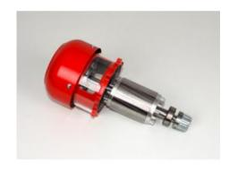
Rotor pour machine asynchrone triphasée avec couple d'extraction sous la forme d'un modèle de travail démontrant le fonctionnement, avec cage en aluminium et bouclier côté opposé à l'entraînement. Le rotor est conçu pour être utilisé avec le stator triphasé (774 7720) ou 739968.
