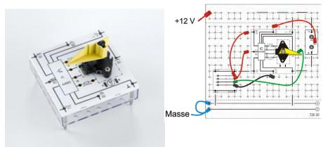
Le composant STE comprend un moteur pas à pas hybride, bipolaire à deux phases, en version à griffes, y compris l'électronique de commande.
