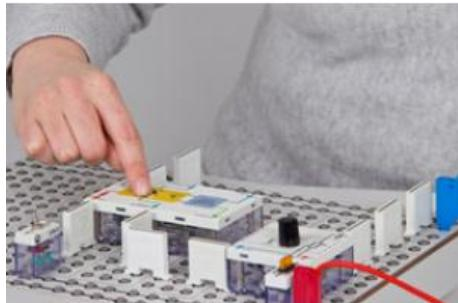
Composants enfichables sur plaque, étude sur le capteur de vitesse de roue magnétorésistif AMR (effet magnétorésistif anisotrope )
