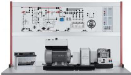
L'alternateur triphasé est une machine synchrone à champ tournant fonctionnant en génératrice. À l'aide d'un champ électrique, il produit une tension alternative triphasée variable en fonction de la vitesse. Comme le circuit de charge est conçu sous forme de réseau à courant continu, cette tension triphasée doit encore être redressée et qui plus est, régulée, puisqu'elle doit rester constante indépendamment du régime du moteur - cette tâche est assumée par le régulateur multifonction.
