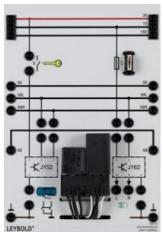
Cet appareil comprend un calculateur pour la commande des deux feux de circulation diurne (FCD) à LED et un calculateur pour l'avertissement d'oubli des feux.
