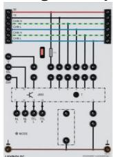
Appareil pour compléter la fonction d'éclairage statique d'intersection pour la Gestion intelligente de l'éclairage automobile 738111 et la commande de l'éclairage de circulation diurne à LED des phares principaux 738166 et 738167.
