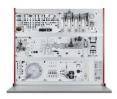
Le système LH-Motronic est réalisé à partir de plaques d'expérimentation classiques avec au dos, le câblage pour le transfert des signaux.
