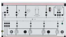
Le dispositif "d'aide au stationnement" de LEYBOLD ® est utilisé pour l'enseignement didactique de la fonctionnalité d'un assistant de stationnement car il peut être utilisé dans tous les véhicules modernes. Il comprend une nouvelle unité de contrôle d'origine capable d'un autodiagnostic, et quatre capteurs à ultrasons d'origine et est un prérequis pour la mise à niveau du système à l'assistant de stationnement dans l'automobile.
