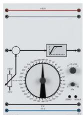
Transmetteur de position avec disque rotatif gradué en angle pour une utilisation dans des systèmes asservis. Avec n?ud additionneur d'entrée pour l'application de grandeurs perturbatrices ou la modification de la valeur de consigne et limiteur de croissance pouvant être mis en circuit avec des temps de montée de 1 V/s à 1000 V/s.
