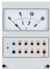
Multimètre à cadre mobile pour la démonstration avec 10 gammes de mesure pour la tension continue et le courant continu.
