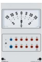
Multimètre à cadre mobile pour la démonstration avec 10 gammes de mesure pour la tension continue et le courant continu.
