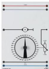
Potentiomètre motorisé avec angle de rotation mécanique de 360° sans butée, angle électrique de 340°  $\pm 5$ °, à moteur à courant continu et entraînement par friction. Sert de modèle de système intégral sans compensation avec temps mort négligeable. Utilisable dans un asservissement de position.
