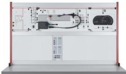
Détection des angles morts : 2 transducteurs à ultrasons détectent si un autre véhicule se trouve dans la zone latérale du véhicule et le signalent par un avertissement optique. Dès que le conducteur a l'intention de changer de voie en actionnant le levier de clignotant en direction du véhicule détecté, un avertissement sonore supplémentaire est émis.
