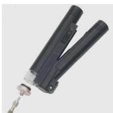
L'appareil est destiné à visualiser les défauts sur la surface de fibres optiques avec un diamètre de court important comme par ex. les fibres optiques HCS 200/230 ou PMMA 980/1000. Le microscope grossit 30 fois et dispose d'un éclairage intégré. L'éclairage se met automatiquement en route à l'ouverture du microscope.
