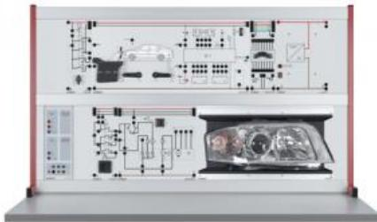
Le législateur exige une correction automatique de la portée déclairage pour les phares au xénon. Ce système d'apprentissage avec simulation intégrée de l'accélération et du freinage (commutable) comprend une correction automatique et dynamique de la portée déclairage en vue de compenser les variations de la hauteur de caisse et donc de l'inclinaison de l'axe du faisceau lumineux produit par les phares du véhicule.
