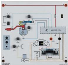
La plaque d'enseignement simule trois calculateurs essentiels pour le diagnostic EOBD et peut générer des données « en direct » ainsi que des dysfonctionnements. Ceux-ci peuvent être transmis à un ordinateur via un adaptateur OBD ( 7379803 ou 7379805 ) ou relevés moyennant un enregistreur de données ( 7379804 ) en vue d'une exploitation ultérieure.
