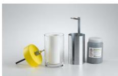
Pour la démonstration du principe de fonctionnement d'une pile saline ou pile sèche charbon-zinc.
