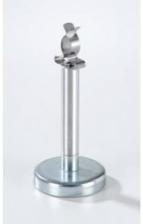
Pince à ressort fixée sur un aimant. Pour la réalisation de montages expérimentaux en chimie sur les tableaux magnétiques ( 666 4659 et 666 4660 ). Peut être utilisé avec tous les modules CPS. Maintient des éléments de 11 à 14 mm de diamètre, par ex. les raccords RN 14 et GL 14.
