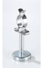
Pince à ressort fixée sur un aimant. Pour la réalisation de montages expérimentaux en chimie sur les tableaux magnétiques ( 666 4659 et 666 4660 ). Peut être utilisé avec tous les modules CPS. Maintient des éléments de 30 à 32 mm de diamètre, par ex. des seringues à gaz et les raccords GL 35.
