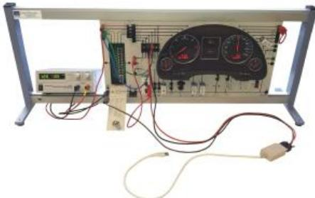
&nbsp; Une partie opérative réelle et très attrayante !!! Support réel pour étudier et comprendre le fonctionnement du réseau multiplexé CAN.
