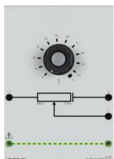
Rhéostat circulaire avec contact de court-circuit, échelle 0 - 100 %.
