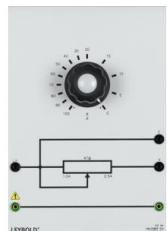
Rhéostat circulaire (enroulement à fil de section décroissante) avec échelle 100 - 0 %.
